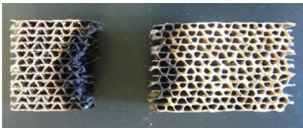
▲処理前基材(左)と多孔質シリカ被膜基材(右)の燃焼試験結果
